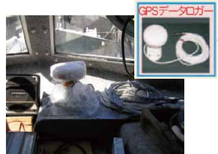
GPS ロガー 漁船の位置データを記録します
