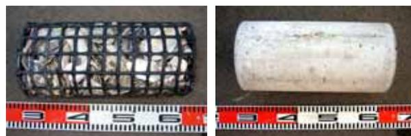
図 1 貝殻テストピース(左)と平面形状テストピース(右)
