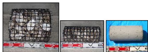
写真-1 使用した供試体（ \phi 30cm、 \phi 15cm貝殻テストピース、平面形状テストピース）
