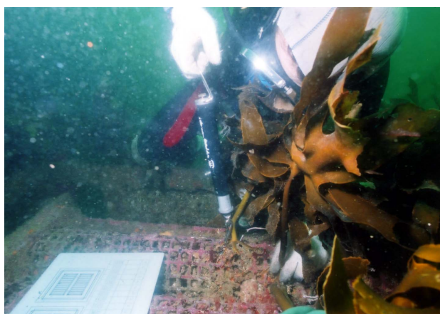
写真2 カジメ固着力測定状況
