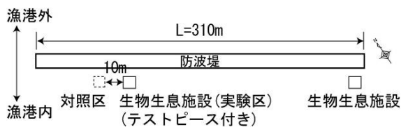
図-3 生物生息施設の設置状況
