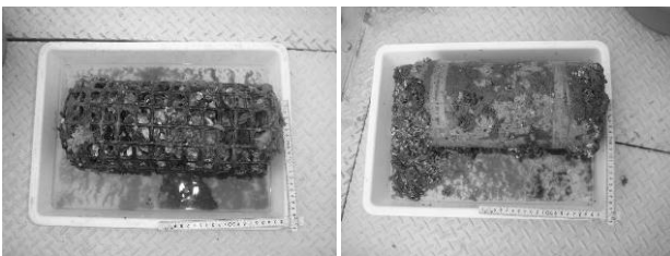
写真-4 引き揚げたテストピース-2007年4月（1年4カ月経過 左：貝殻基質、右：コンクリート基質）
